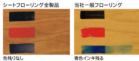
試験方法 青色インキ、赤色クレヨン、黒マジックを24時間放置した後、溶剤でふき取り、表面状態をみる。(JAS合板、当社オリジナル)
